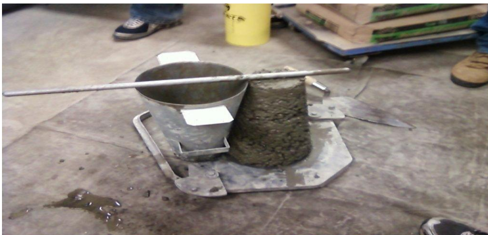
Fig.12 Slump Cone Test
