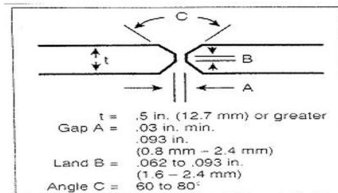
**Figure 3: Weld Edge Preparation**
