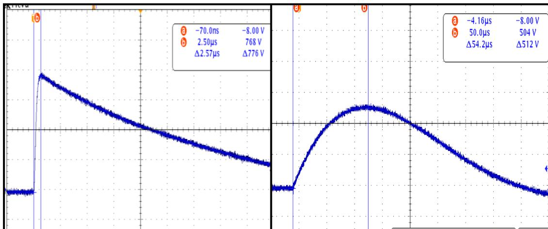
Figure 3 : Impulse Voltage 2.5/50  $\mu$ s
