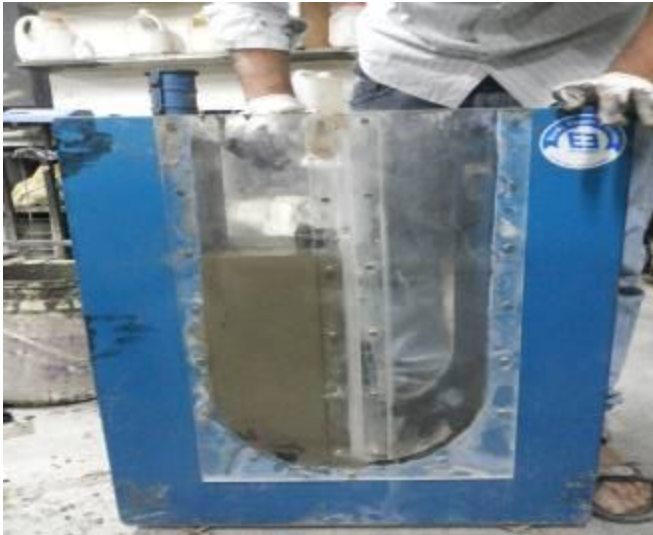
Fig: 10 U Box Test
