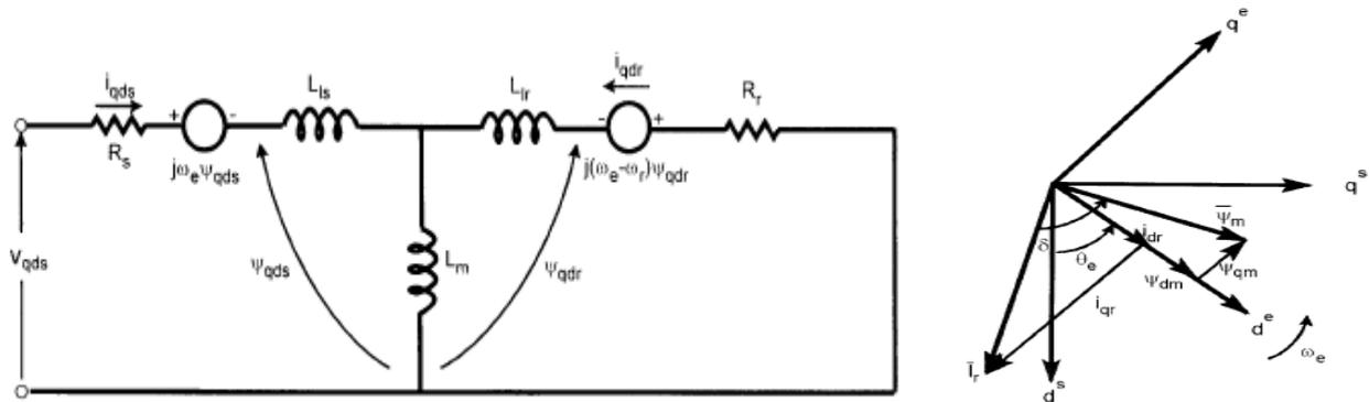
Figure 4. Complex synchronous frame dq equivalent circuit.
