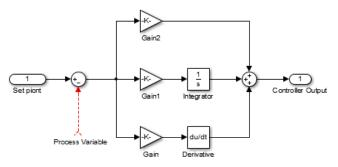
Fig. 1 : PID Block Diagram
